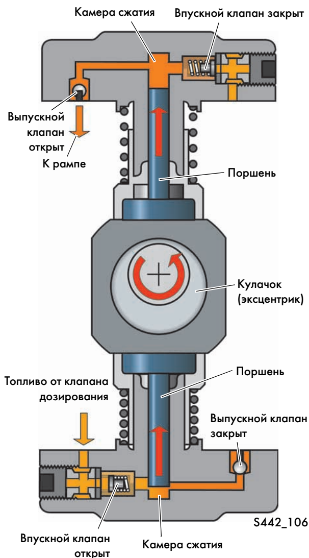
Модуль насоса высокого давления
